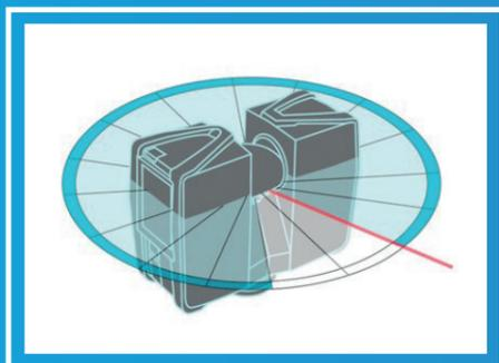
Nous utilisons la dernière technologie de scanner 3D type FARO Focus établissant des nuages de points précis.
